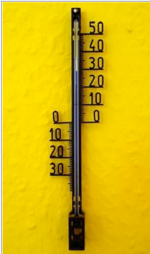
Abb. 1: Im Haushalt gebräuchliches Flüssigkeitsthermometer. In dem Gehäuse befindet sich ein Glasrohr, in dem eine gefärbte Flüssigkeit aufsteigen kann.
