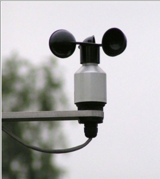
Abb. 6: Anemometer, ein Messgerät für die Windgeschwindigkeit
