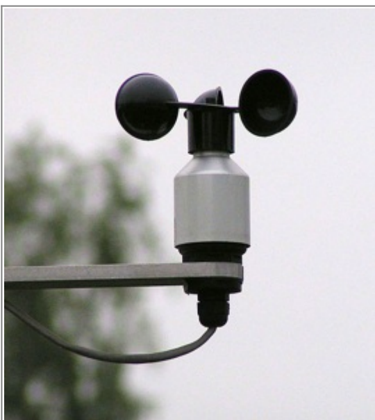
Abb. 6: Anemometer, ein Messgerät für die Windgeschwindigkeit
