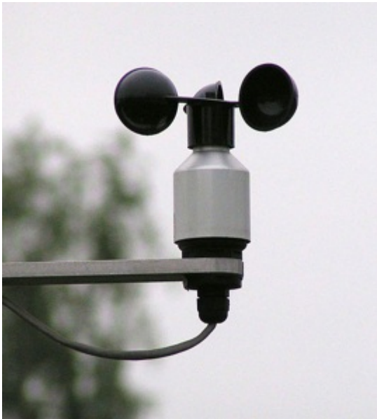
Anemometer, ein Messgerät für die Windgeschwindigkeit
