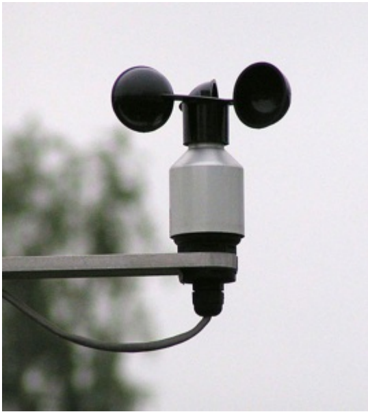
Anemometer, ein Messgerät für die Windgeschwindigkeit
